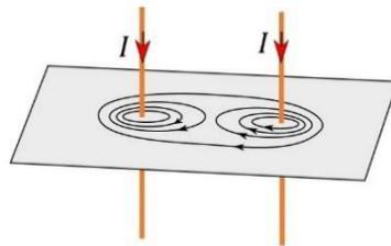
القوة التي تؤثر في الموصل الأيمن يكون اتجاهها باتجاه  $(-x)$ ، والقوة التي تؤثر في الموصل الأيسر تكون باتجاه  $(+x)$ .
