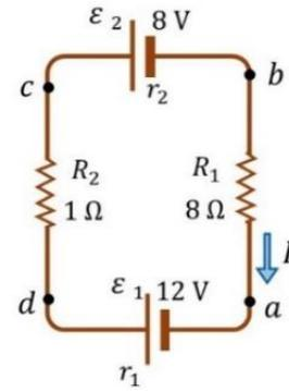
أستنتج من الإشارة الموجبة أنّ اتجاه التيار بالاتجاه المفترض؛ أي أنّ التيار يسري في الدارة مع اتجاه حركة عقارب الساعة. وهو تماماً ما تم استنتاجه في حل المثال عندما افترضت اتجاهها مختلفاً للتيار. وأستنتج أنني أتوصل إلى اتجاه التيار الحقيقي بغض النظر عن الاتجاه الابتدائي الذي أفترضه لسريان التيار.
